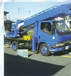
施工機(建柱車)
