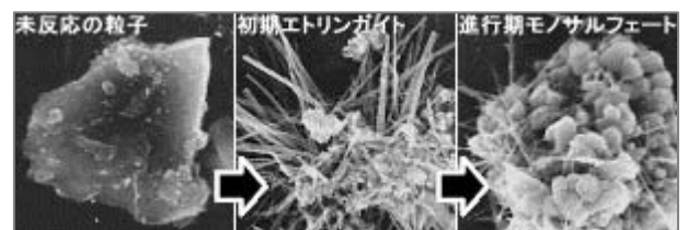
写真3 水和反応によるセメント粒子の変化
