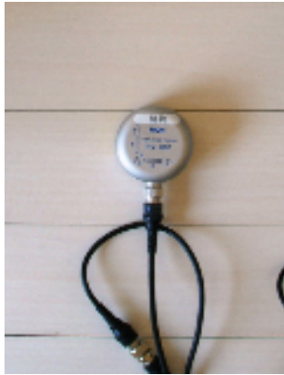
写真.2 振動ピックアップ
