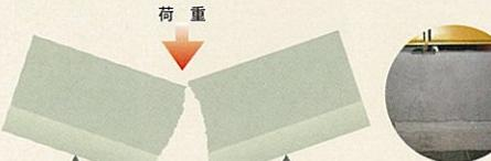
●最大荷重: 34.3kNで破壊
